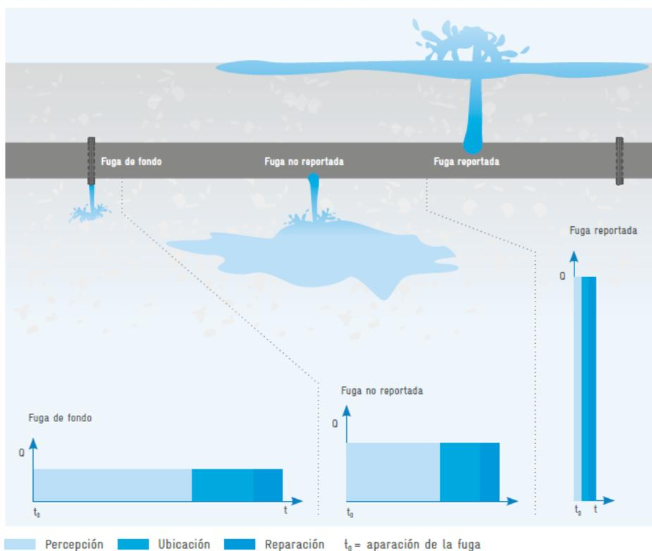
Figura 1. Relación entre tasa de fuga (Q) y tiempo de fuga (t).
