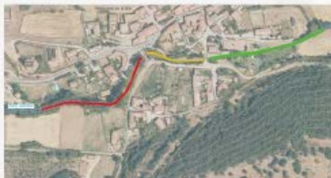
La limpieza se realizara en los tres tramos definidos, mediante medios manuales y retroexcavadora conforme a la autorización de la confederación hidrográfica del Ebro.
